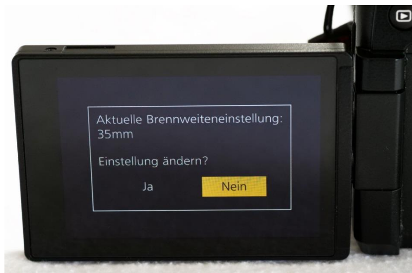
Bild 1: Brennweiten-Einstellung für adaptierte Objektive
